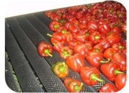
sistema de rodillos para eliminar el exceso de agua.
