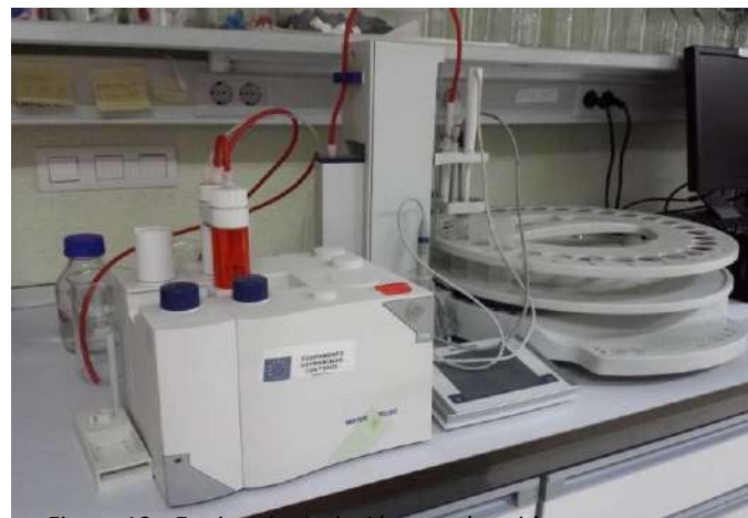
Figura 13.- Equipo de titulación para la acidez
