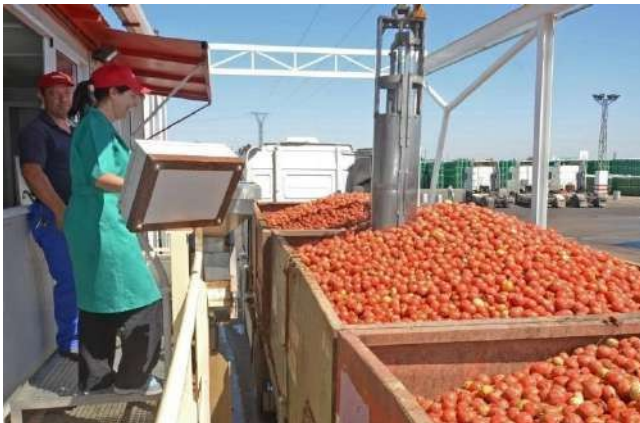
Figura 2.- Dispositivo de toma de muestras de tomates para conserva
