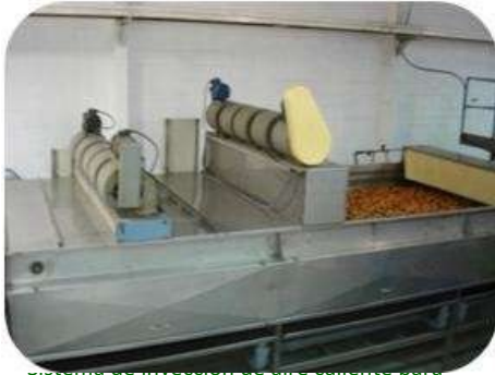
sistema de inyección de aire caliente para el secado de verduras.
