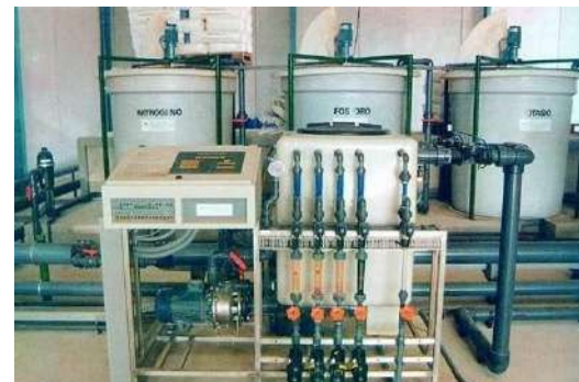
Fig. 26. Cabezal de riego para fertirrigación
