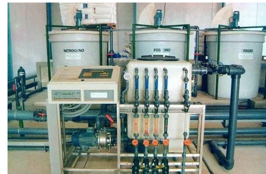
Fig. 26. Cap de irigare pentru fertirigare
