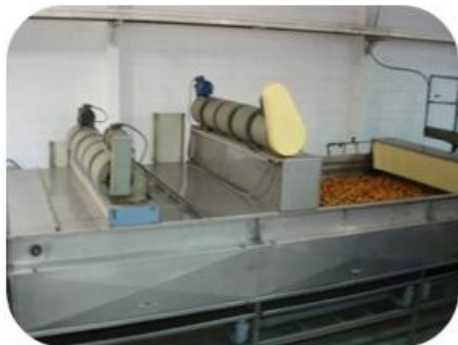
Sistem de injecție cu aer cald pentru uscarea legumelor.
