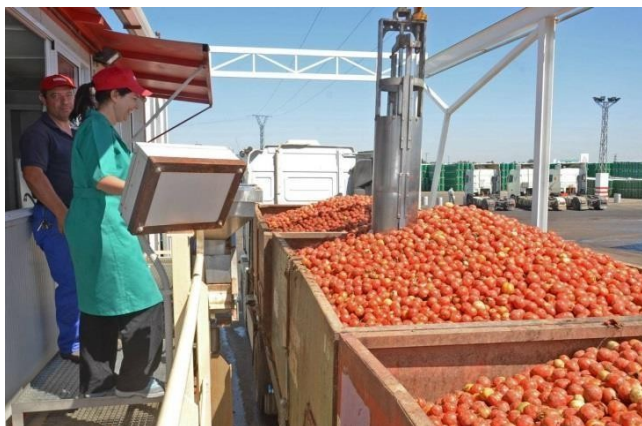
Figura 2.- Dispozitiv de prelevare a probelor de roșii pentru conserve
